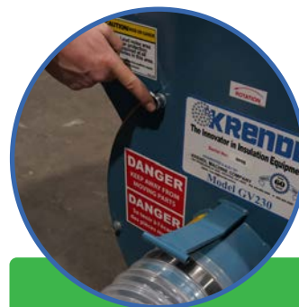
5. Dévisser les écrous de la chambre du ventilateur
