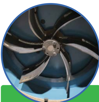
7. Nettoyer la chambre du ventilateur et éliminer l'accumulation d'isolant sur le ventilateur
